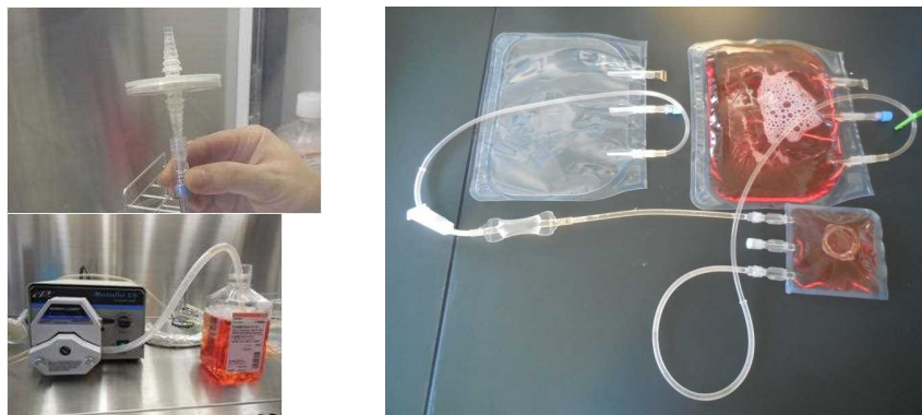
図3. 無菌充填とリーク試験・無菌試験
