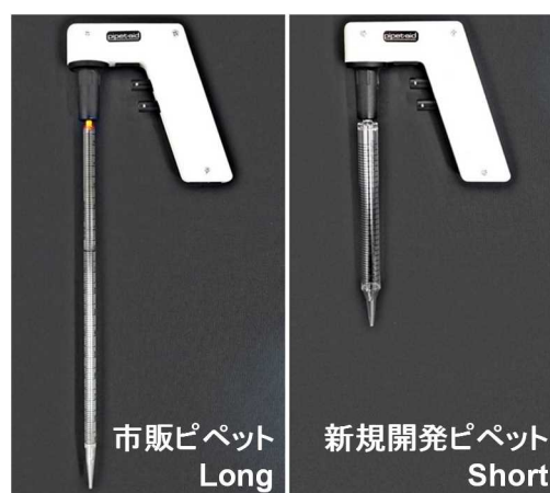
図 5 ピペット外観の比較（電動ピペッターに装着時） (左) 従来品 10 mL ピペット、(右) 新規開発した短いピペット
